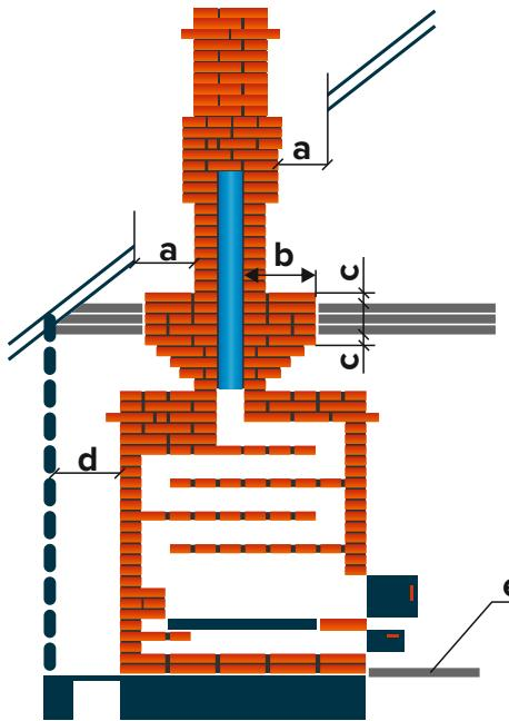
**a** = 130мм – от наружных поверхностей кирпичных или бетонных дымовых труб до стропил, обрешётки и других деталей кровли из горючих материалов.
